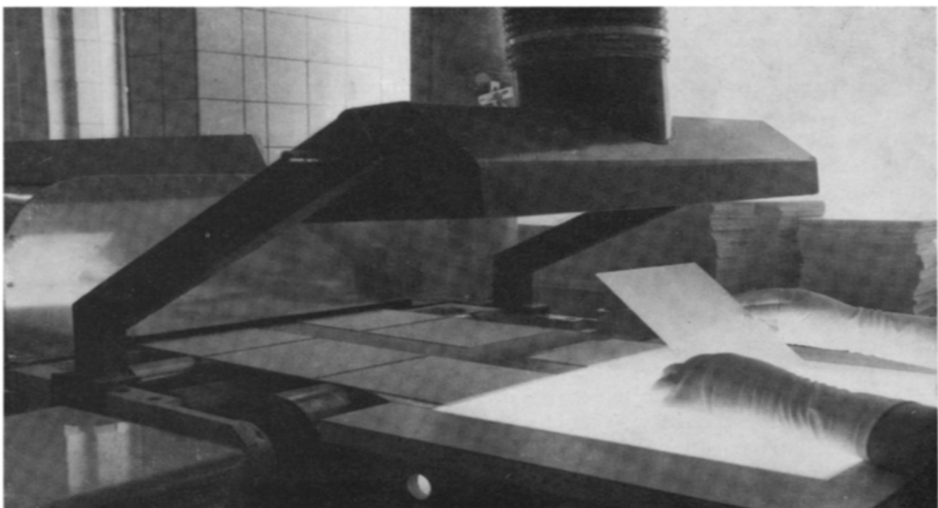
Fig. 3. Überprüfung der DC-Fertigplatten nach Austritt aus dem Trockenkanal (Fotografie E. Merck AG, Darmstadt).
