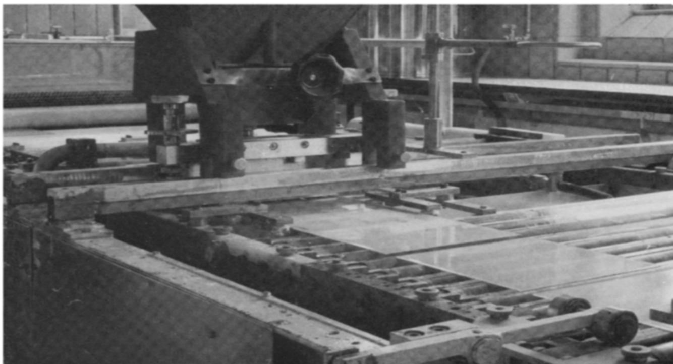
Fig. 2. Maschinelle Beschichtung von DC-Fertigplatten (Fotografie E. Merck AG, Darmstadt).
