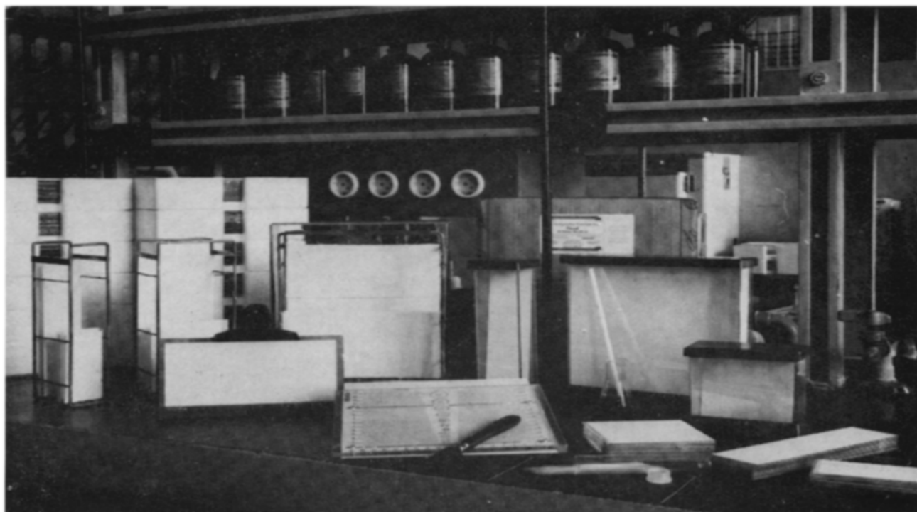
Fig. 11. Chromatographie an DC-Fertigplatten verschiedener Grösse (Fotografie E. Merck AG, Darmstadt).
