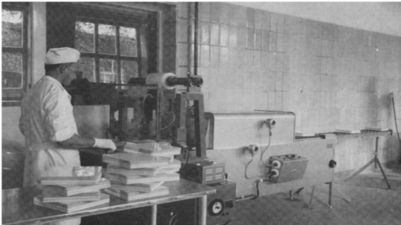
Fig. 5. Einschweissen der DC-Fertigplatten in Folien (Fotografie E. Merck AG, Darmstadt).
